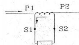
در زمان اتصال ترانسفورماتورهای جریان به تجهیزات فشار ضعیف در صورتیکه تنها مقدار جریان برای ما با اهمیت باشد نیاز به در نظر گرفتن پلاریته ها نیست لکن در صورتی که جهت جریان تعیین کننده عملکرد سیستم باشد حتماً باید به پلاریته ها توجه نمود مثال بارز این مسئله رله های دیفرانسیل یا خطای اتصال زمین محدود یا RESTRICTED EARTH FAULT می باشد که براساس تفاوتی از جریان های عبوری چند ترانسفورماتور جریان کار می کنند لذا لازم است که در حین اتصال مدارهای جریانی به این رله ها مسئله فوق را مدنظر داشت.
